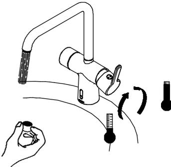
När blandaren är monterad så skall strålsamlaren demonteras för att spola ur blandare och rör under 20–30 sekunder. Spola med varmt och kallt vatten.
