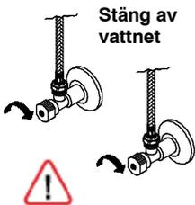
Vattnet skall alltid stängas av vid planerat underhåll, för att undvika vattenskador.
